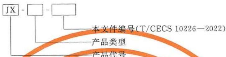
示例：Ⅲ型混凝土抗裂硅质防水剂标记为：JX-Ⅲ-T/CECS 10226—2022。
